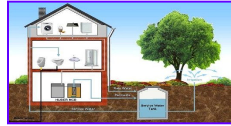
شكل (٢٢) معالجة المياه الرمادية وإعادة استخدامها
